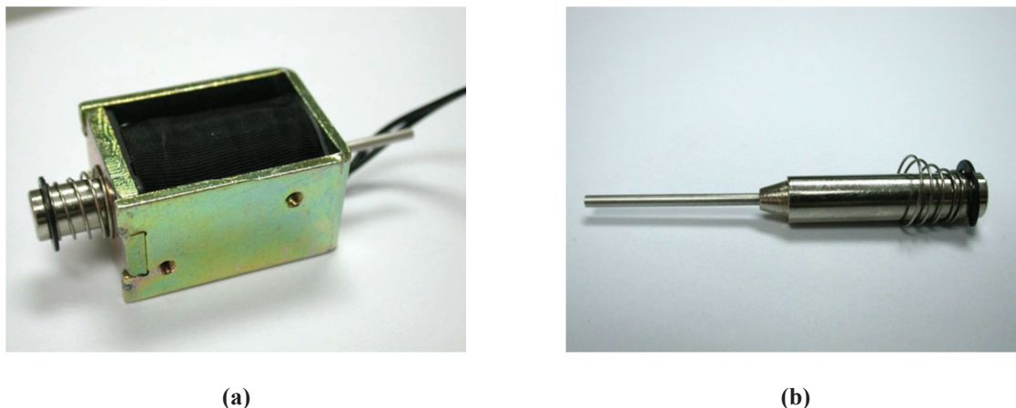
Figura 17: Solenóide (a) e seu plunger (b)
