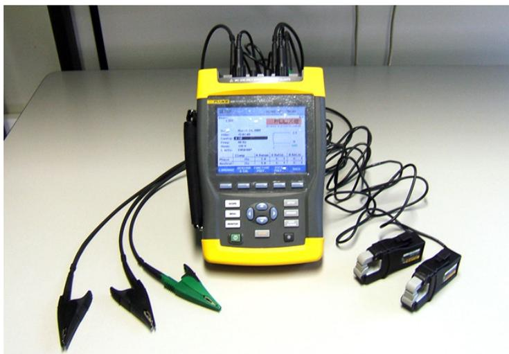
Figura 5.5: Analisador de energia modelo 435 da Fluke (Fonte: Fernandes, 2009).
