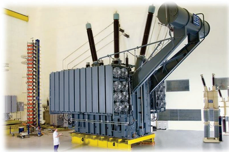
Figura 1.1: Transformador de Potência 225 MVA e 275KV [2].
