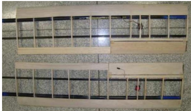
Figura 6 Estrutura da asa do Mini UAV
