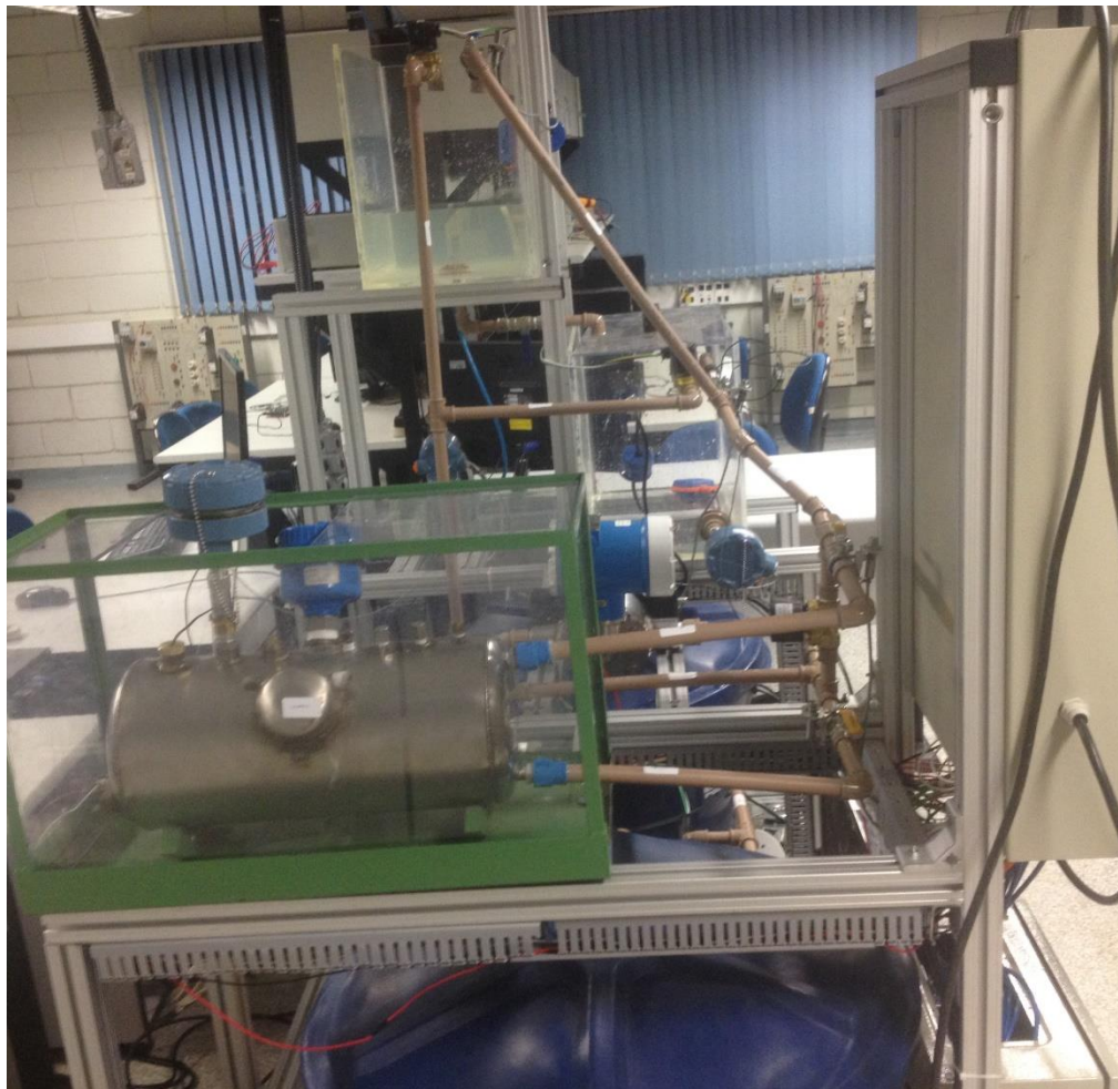
Figura 16 - Malha de temperatura com a caldeira e o sensor pt1000
