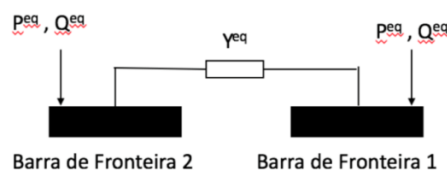
Figura 15: Esquemático do sistema equivalente obtido
