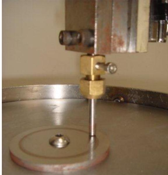
Figura 7.1 – fixação dos corpos de prova
