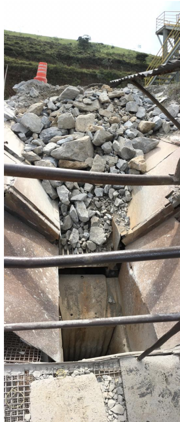
Figura 1.3: Alimentador do britador primário da Pedreira Santa Cornélia
