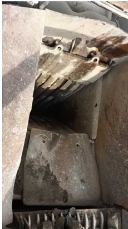
Figura 1.2: Britador primário da Pedreira Santa Cornélia
