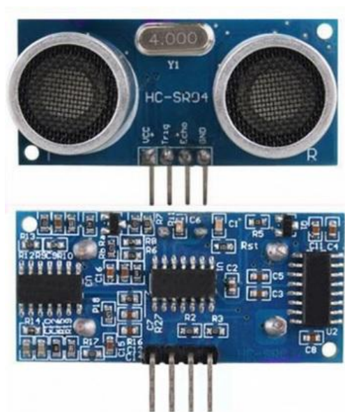
Figura 12: Módulo de sensoriamento por ultrassom
