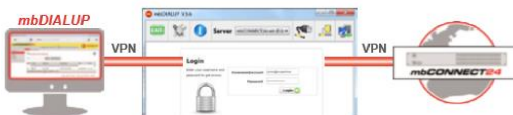
FIGURA 23: Conexão entre o computador com o portal via mbDIALUP
