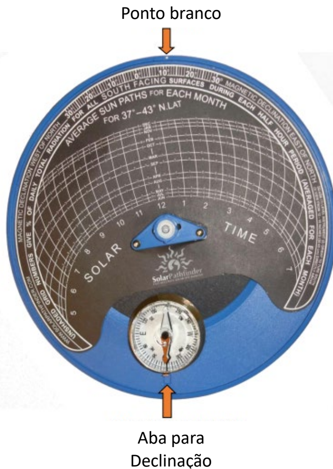
Figura 9: Exemplo de diagrama de caminho solar.
