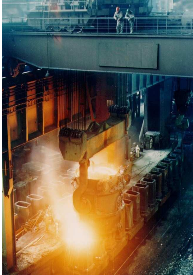
Figura 15 - Aplicação de ponte rolante em uma usina siderúrgica
