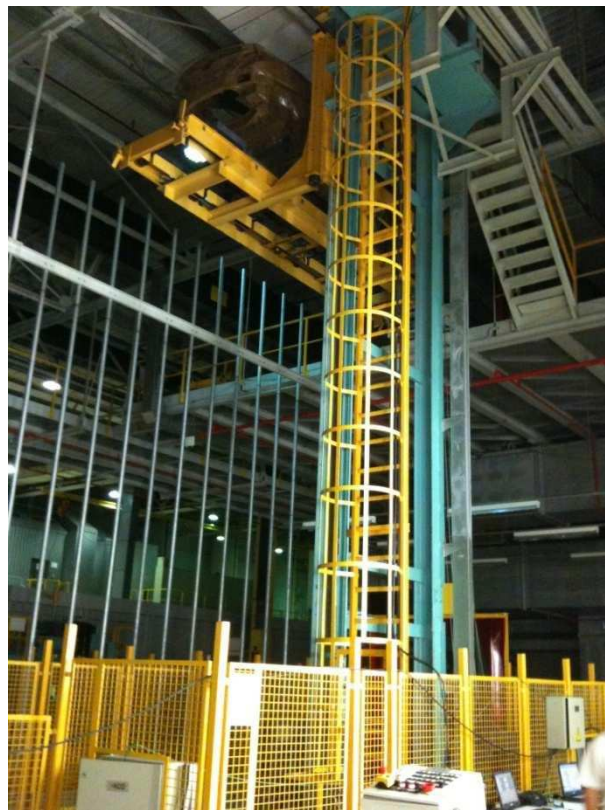
Figura 38 - Carroceria transportada para o terceiro andar
