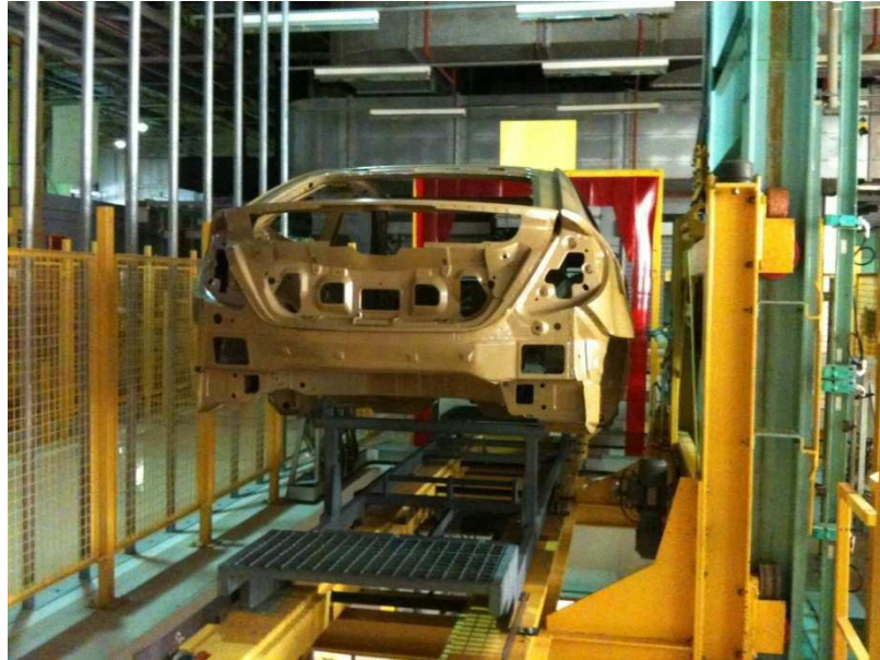
Figura 37 - Carroceria pronta para ser elevada
