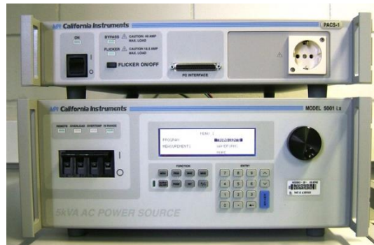
Figura 3.2 – Fonte de alimentação programável e analisador de energia.
