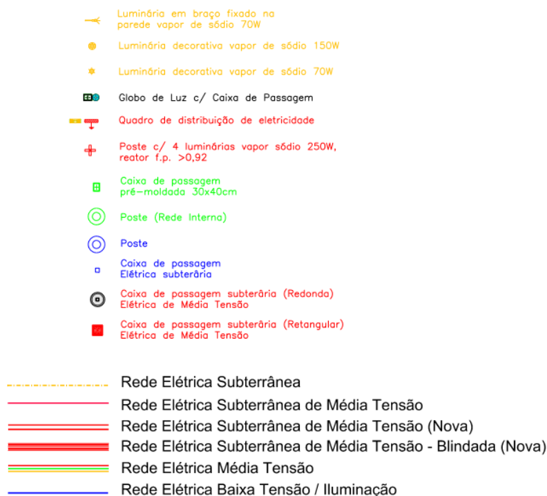
Figura 4.2 – Legenda dos elementos principais da planta da rede primária.
