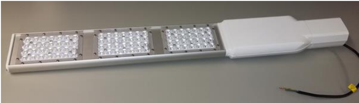
Figura 3.6 – Lâmpada LED de 3 módulos utilizada durante os ensaios laboratoriais.
