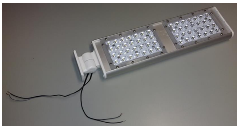
Figura 3.7 – Lâmpada LED de 2 módulos utilizada durante os ensaios laboratoriais.
