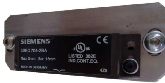
Figura 42: Detalhe da chave magnética de segurança de porta.
