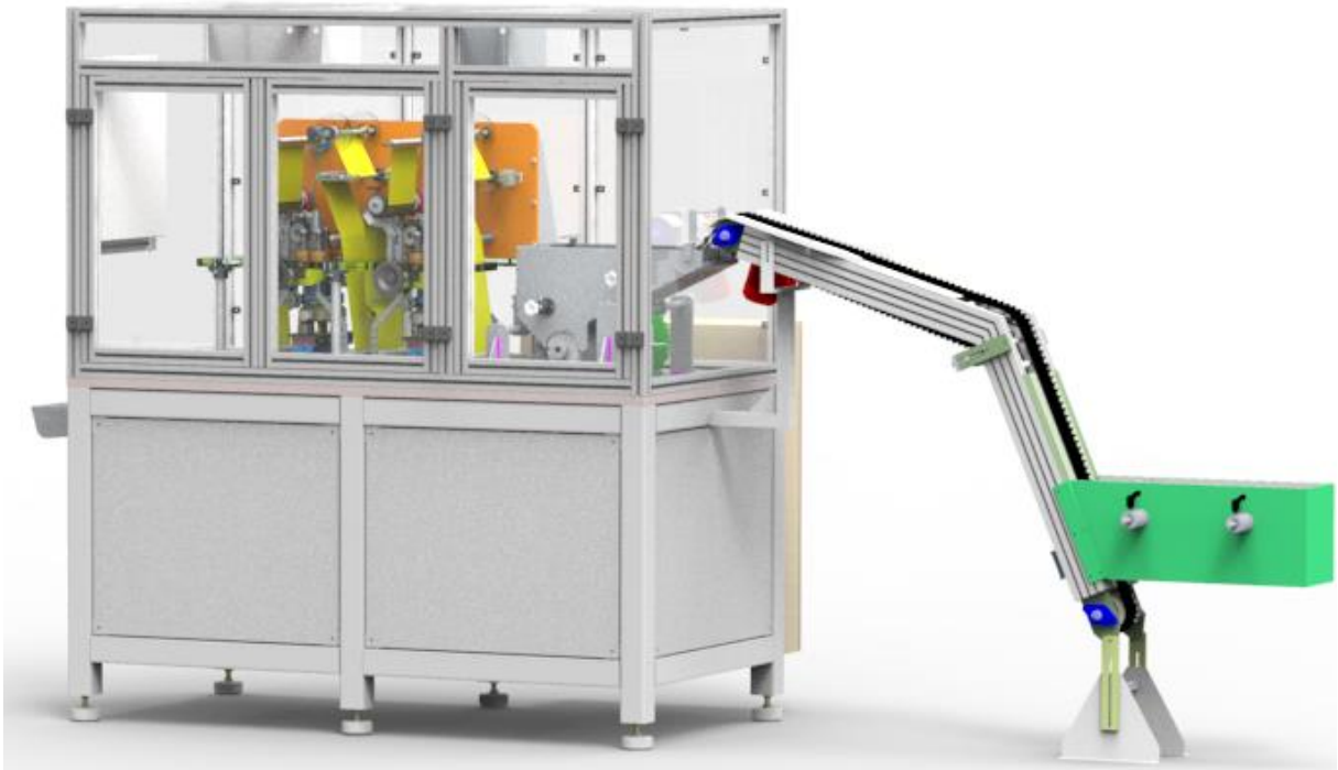
Figura 20: Projeto de enclausuramento da máquina.
