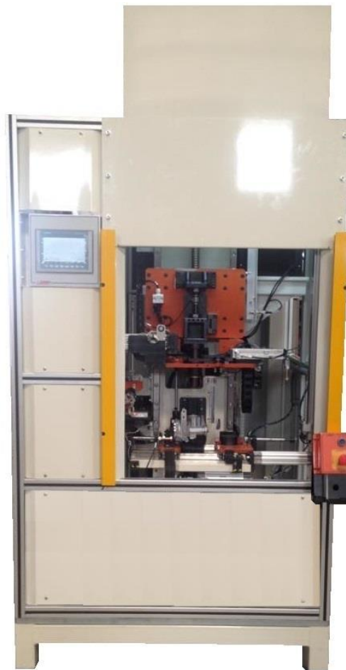
Figura 30: Mecanismo da máquina de gravação do código de rastreabilidade e de inserção de rolamento e anel elástico na carcaça principal.
