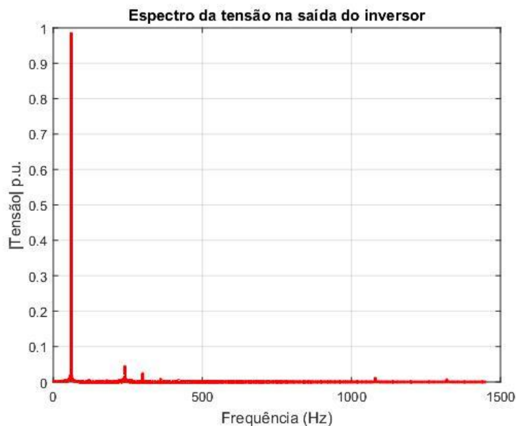
Figura 4.10 - Espectro da onda de tensão na saída do inversor.
