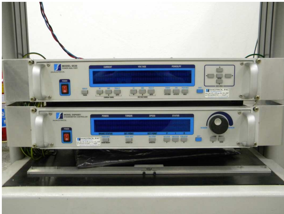
Figura 4.9 – De cima para Baixo: Three-Phase Power Analyzer Model 6530 e o Controlador Programável DPS 6001 (Tecumseh).
