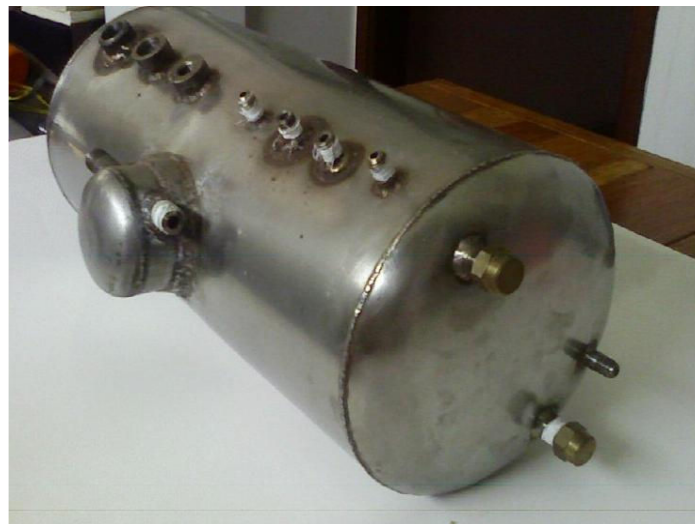
Figura 8 - Caldeira sem equipamentos acoplados.
