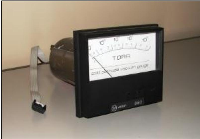
Figura 8: medidor de alto vácuo.
