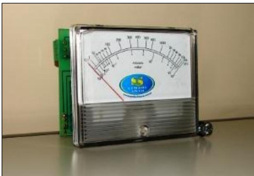
Figura 12: medidor do sensor de médio vácuo.
