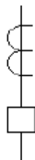
Figura 2.24: Representação de um TC utilizada nos diagramas unifilares de barramentos de subestação. Aqui, no caso, o TC está em série com um disjuntor [16]
