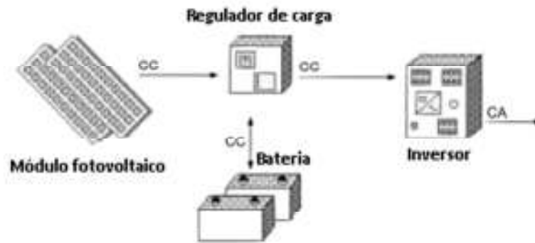
Figura 1 - Componentes de um sistema fotovoltaico
