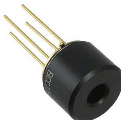
Figura 6 - Ilustração do sensor infravermelho MLX90614 utilizado
