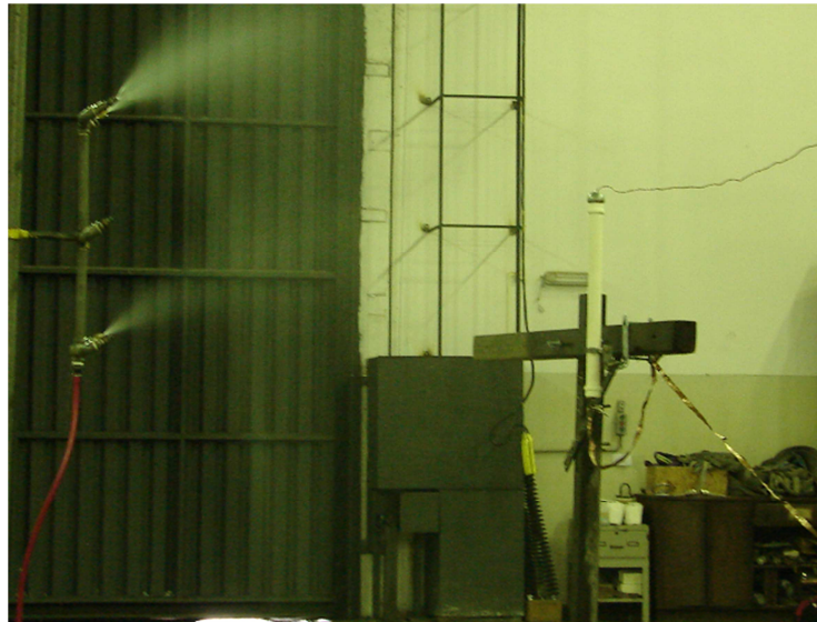
Figura 23 - Ensaio de tensão senoidal aplicada, com o sensor submetido à simulação de chuva
