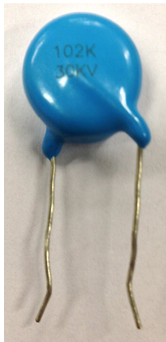
Figura 22 - Capacitor de 1nF e 30kV
