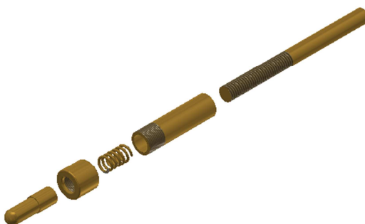
Figura 9 - Vista explodida do eletrodo superior do invólucro
