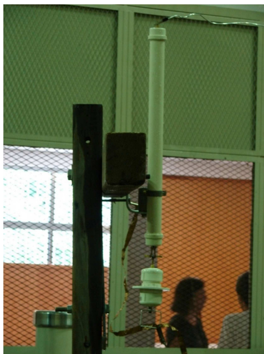
Figura 6 - Divisor capacitivo com invólucro acoplado em presilha
