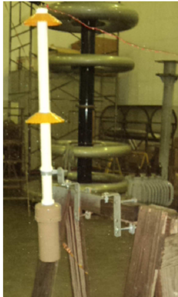
Figura 26 - Ensaio de tensão alternada sob simulação de chuva no conjunto definitivo
