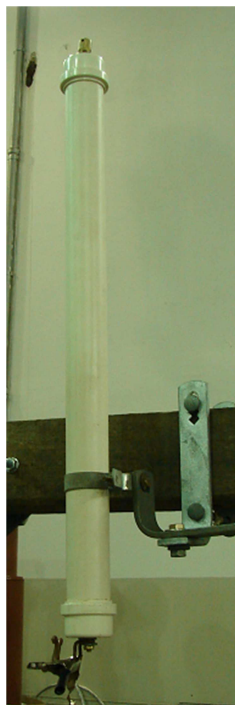
Figura 5 - Divisor capacitivo blindado em cruzeta de madeira para ensaio
