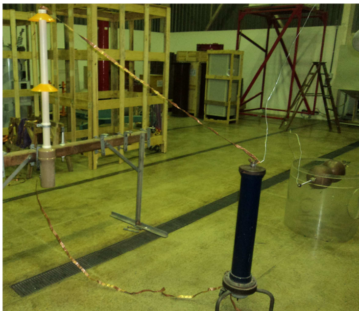
Figura 25 - Divisor capacitivo e invólucro em ensaio de impulso de tensão
