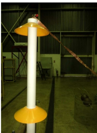
Figura 31 - Divisor capacitivo finalizado com eletrodo de alta tensão conectado ao gerador de sinais
