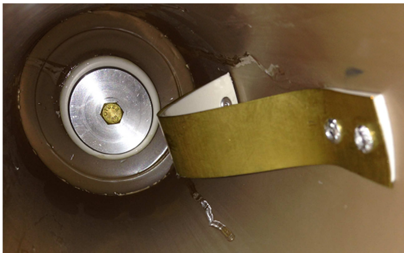
Figura 37 - Detalhe da mola de PVC com revestimento de chapa de latão fixada ao prensa cabo
