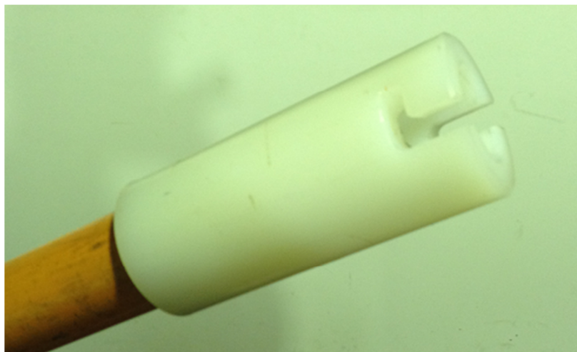
Figura 39 - Detalhe da haste de manobra do invólucro para fixação dentro do abrigo
