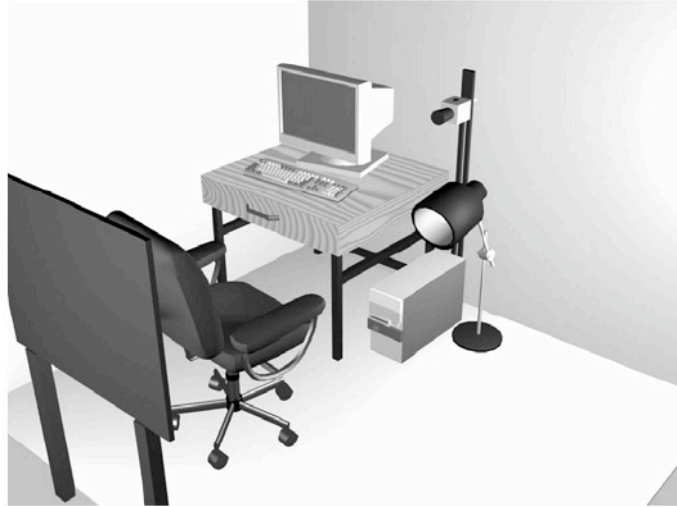
Figura 4.4 Esquema de configuração física proposta para o rastreamento do movimento dos dedos. Fonte: (GEJGUS et al., 2004).
