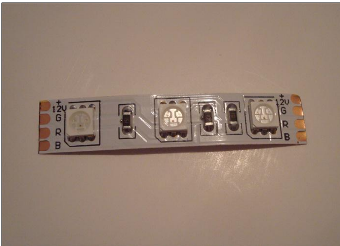
Figura 24 - Segmento de fita de LEDs RGB.
