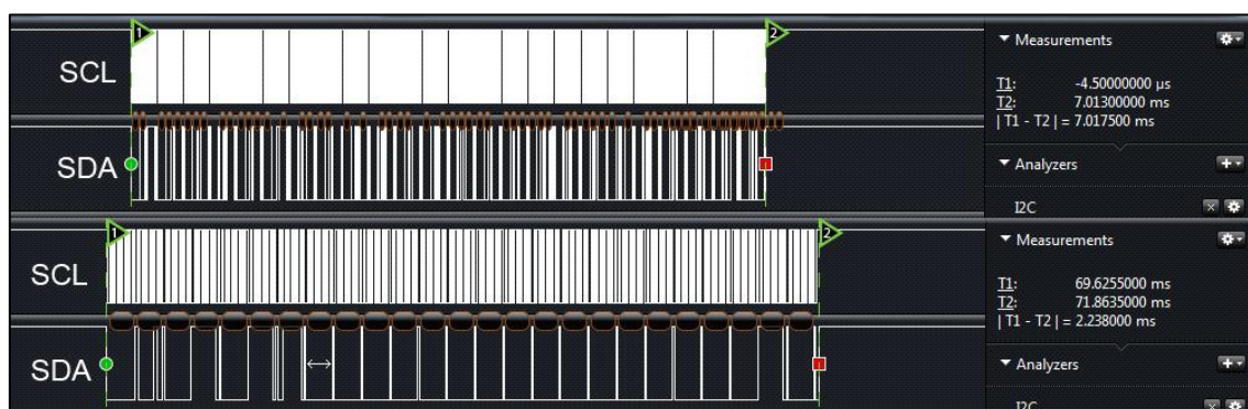
Figura 35 - Linha I2C de comunicação entre o microcontrolador e o PCA 9626.
