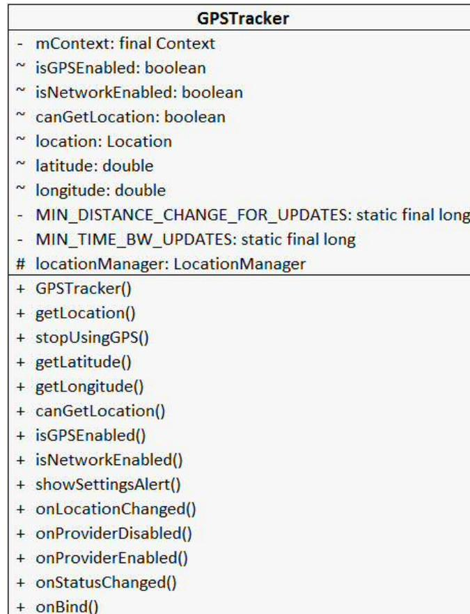
Figura 4.18: Diagrama de Classe UML da Classe GPSTracker
