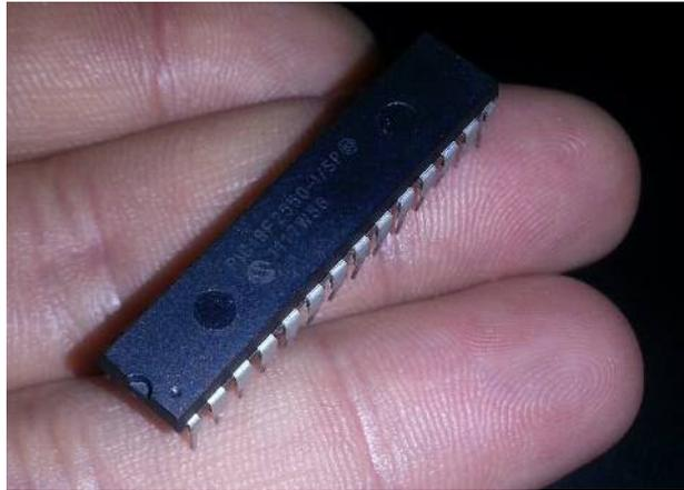
Figura 4.9: Microprocessador PIC 18F2550 da Microchip
