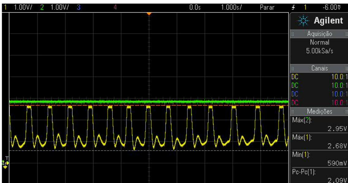
Figura H.6: Resposta do Sensor Quando Alimentado com 2,95v
