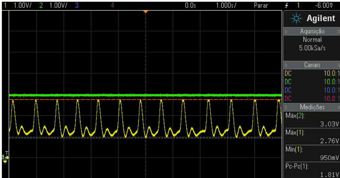
Figura H.1: Resposta do Sensor Quando Alimentado com 3v
