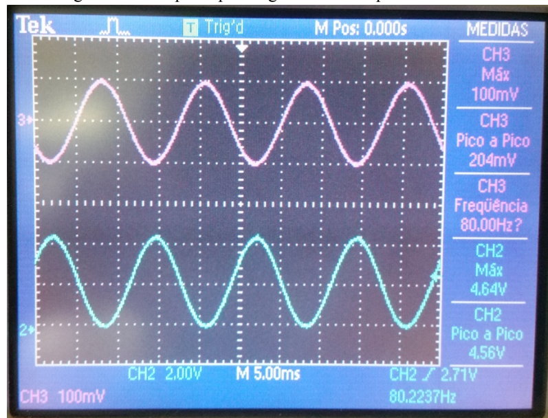
Figura 30 – Resposta para o gerador de frequência em 80 Hz
