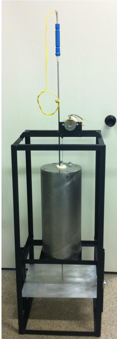
Figura 35 - Equipamento para realizar o teste de inflamabilidade pronto
