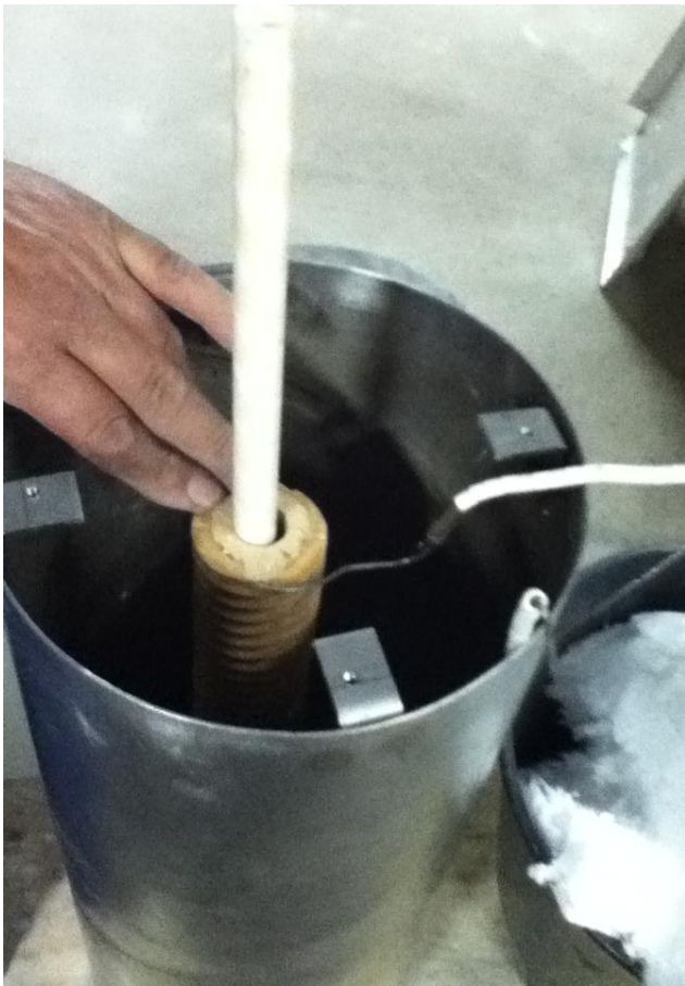
Figura 9 - Construção do forno: centralização da cerâmica com a resistência Kanthal A1 enrolada
