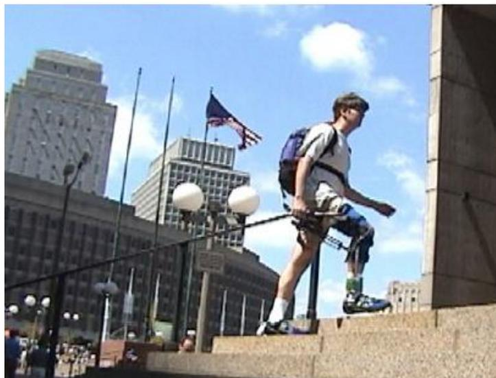
Figura 4 – Exoesqueleto RoboKnee.
