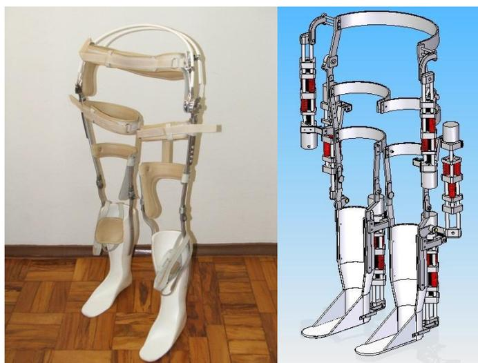
Figura 9 – Órtese adquirida para o projeto (esquerda) e projeto do exoesqueleto para membros inferiores (direita).
