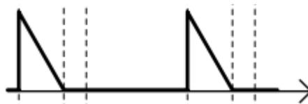
A corrente na chave no modo de condução contínua é representada pela figura 15. Ela é complementar à figura 13 e bastante influenciada pela resistência da mesma, portanto a escolha da chave deve ser bastante criteriosa.
