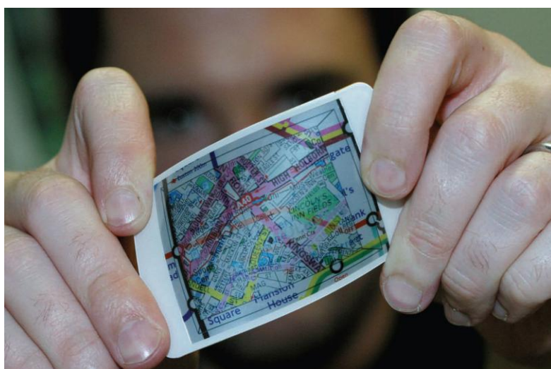
Figura 4.5.1: Protótipo da interface Gummi da Sony mostrando navegação em um mapa. [67]
