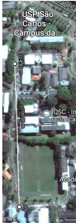
Figura 44: Máximo alcance obtido no teste realizado com o transceptor RF.
