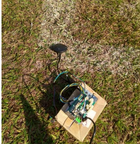
Figura 45: Fotografia do teste realizado com o receptor GPS.
