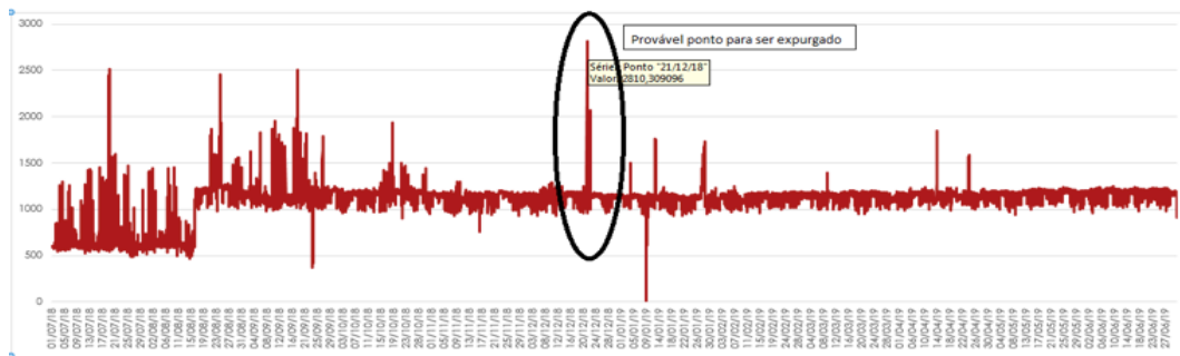
Figura 1 - Medição da potência aparente de uma real subestação em kVA em função da data.
