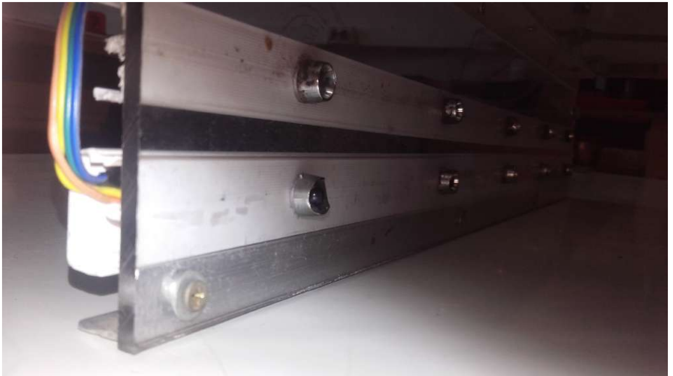
Figura 4.2: Bocal de fototransistor danificado pelo chute. Fonte: Elaborada pelo autor.
