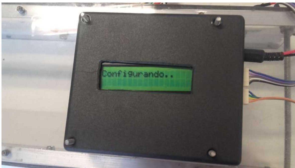
Figura 3.12: Tempo para configuração do microcontrolador e do LCD. Fonte: Elaborada pelo autor.
