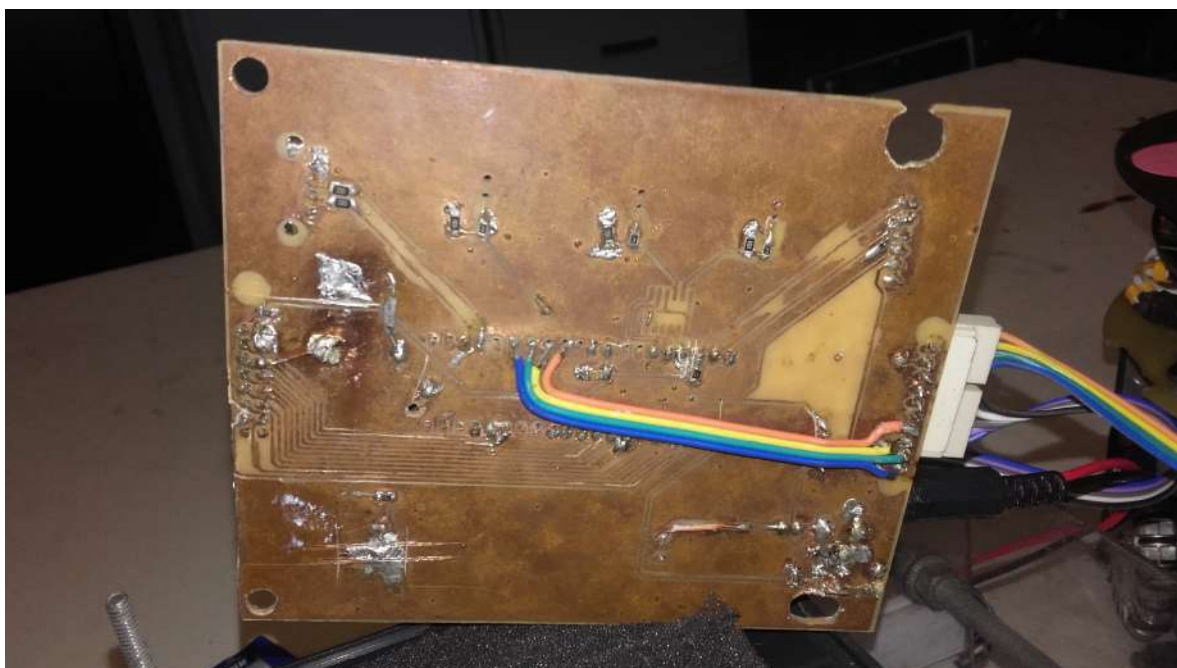
Figura 3.7: PCB soldada por baixo. Fonte: Elaborada pelo autor.
