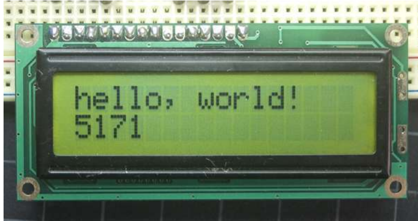
Figura 2.5: Módulo de display LCD comumente usado em instrumentações simples. Fonte: Elaborada pelo autor.
