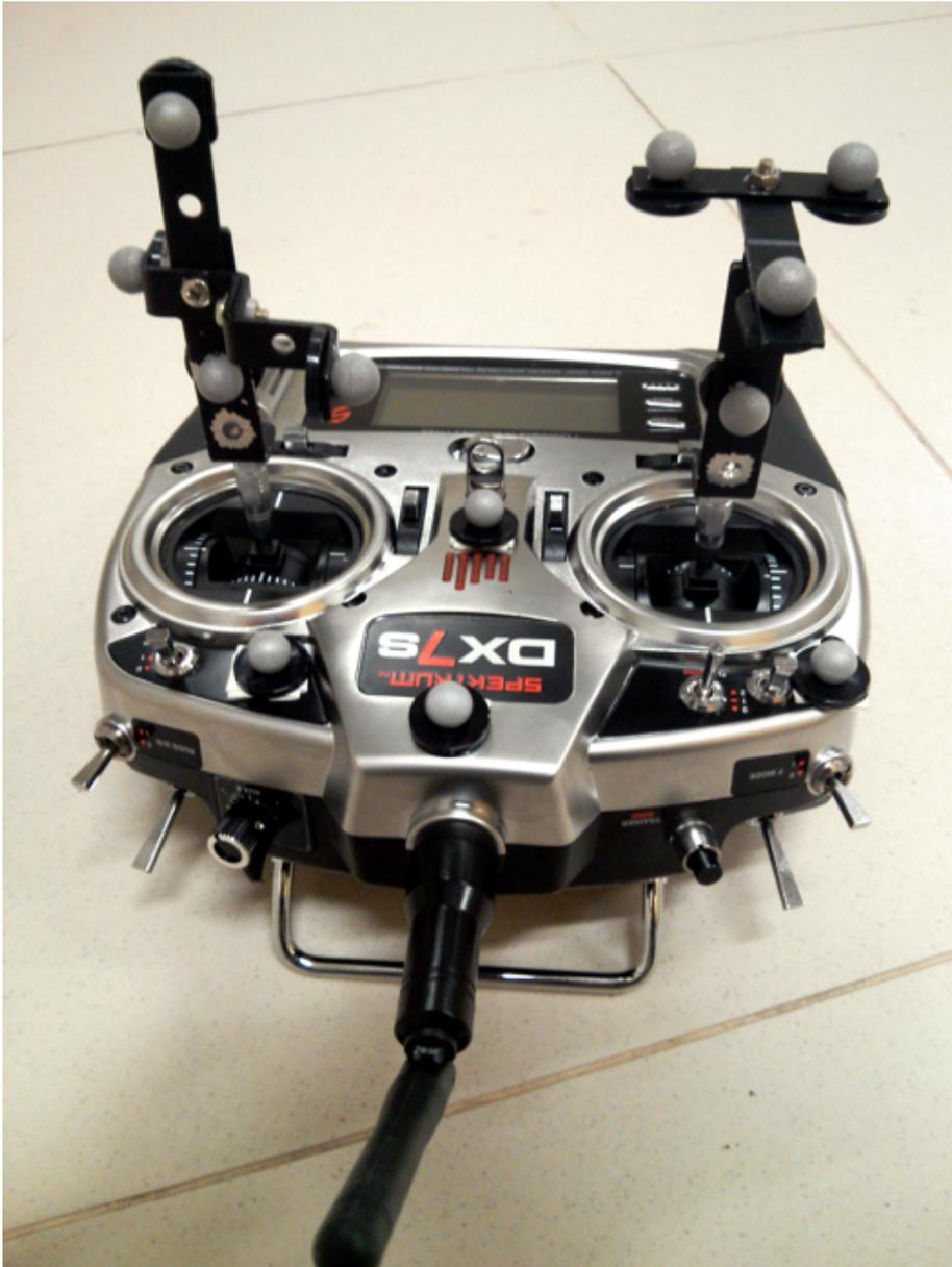
Figura 10 – Rádio *Spektrum* modelo *DX7s*, com os marcadores de identificação das câmeras.
