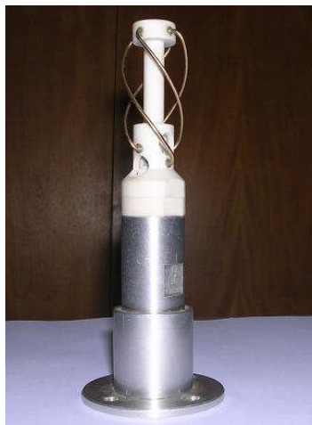
Figura 4. Antena em Banda-S Utilizada nos Satélites CBERS-1 e 2.
