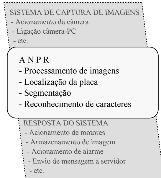
Figura 4.1: Esquema de um sistema completo de ANPR, com destaque para o núcleo do sistema
