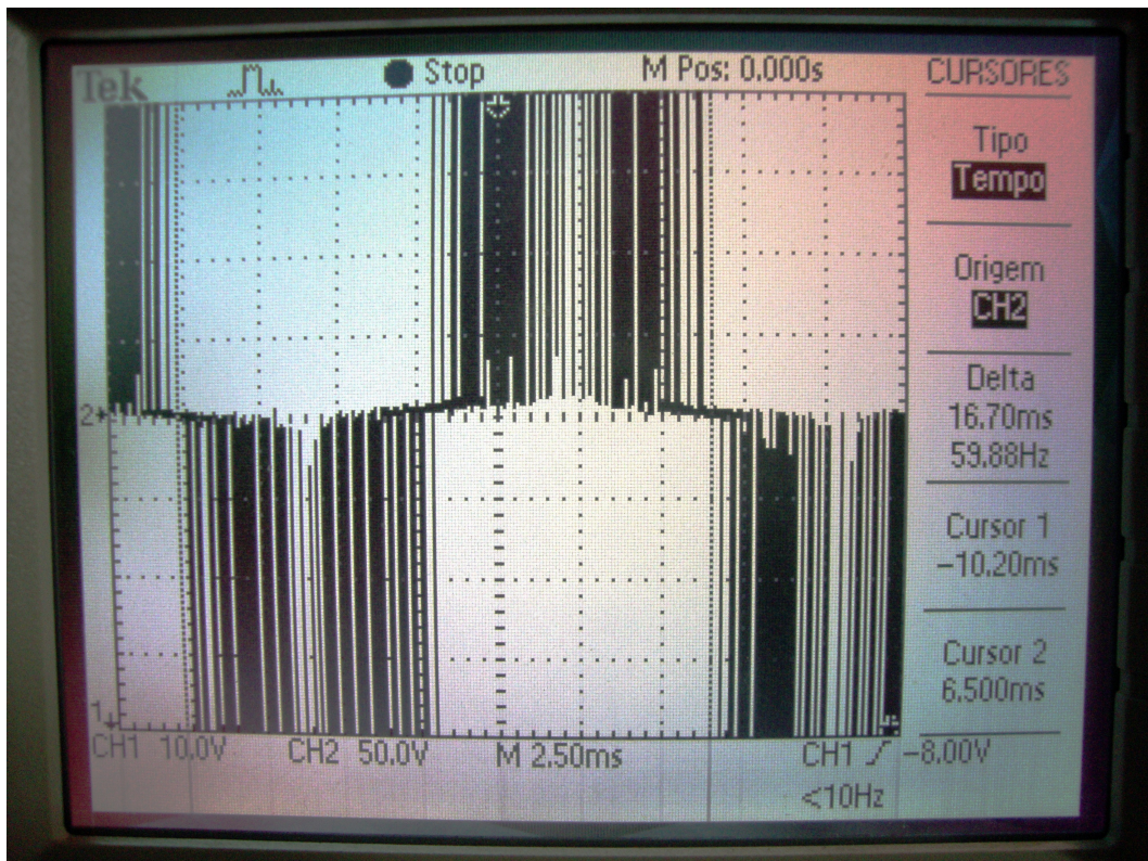
Figura 3.20: Forma de onda da saída do inversor de frequência em 60,2Hz.
