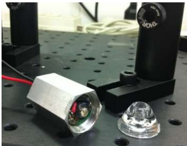
Figura 20 – LED ultravioleta e lente convergente utilizado para excitação das amostras.
