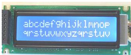
Figura 27: Exemplo de LCD com 2 linhas e 16 caracteres.
