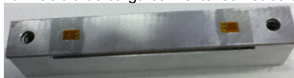
Figura 29 – Célula de carga com extensômetros colados.
