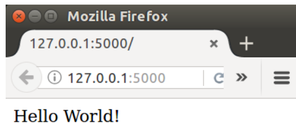
Figura 13 – Resposta do servidor Flask ao acesso da rota "/ .
