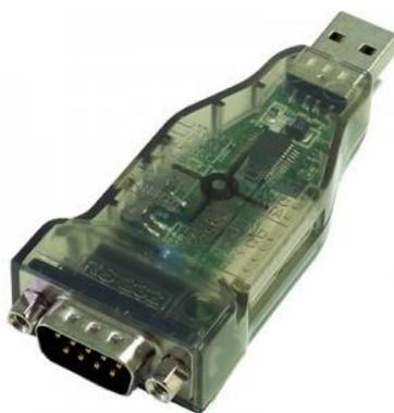
**Figura 3.8 - Interface USB entre computador e motor USB2Dynamixel**
