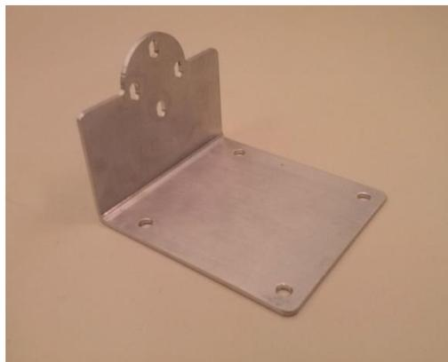
**Figura 3.10 - Peça de acoplamento entre o motor e o sensor**
