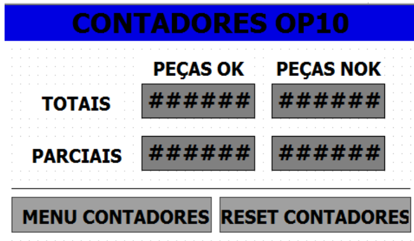
Figura 15: Tela da IHM referente aos contadores totais e parciais da máquina.
