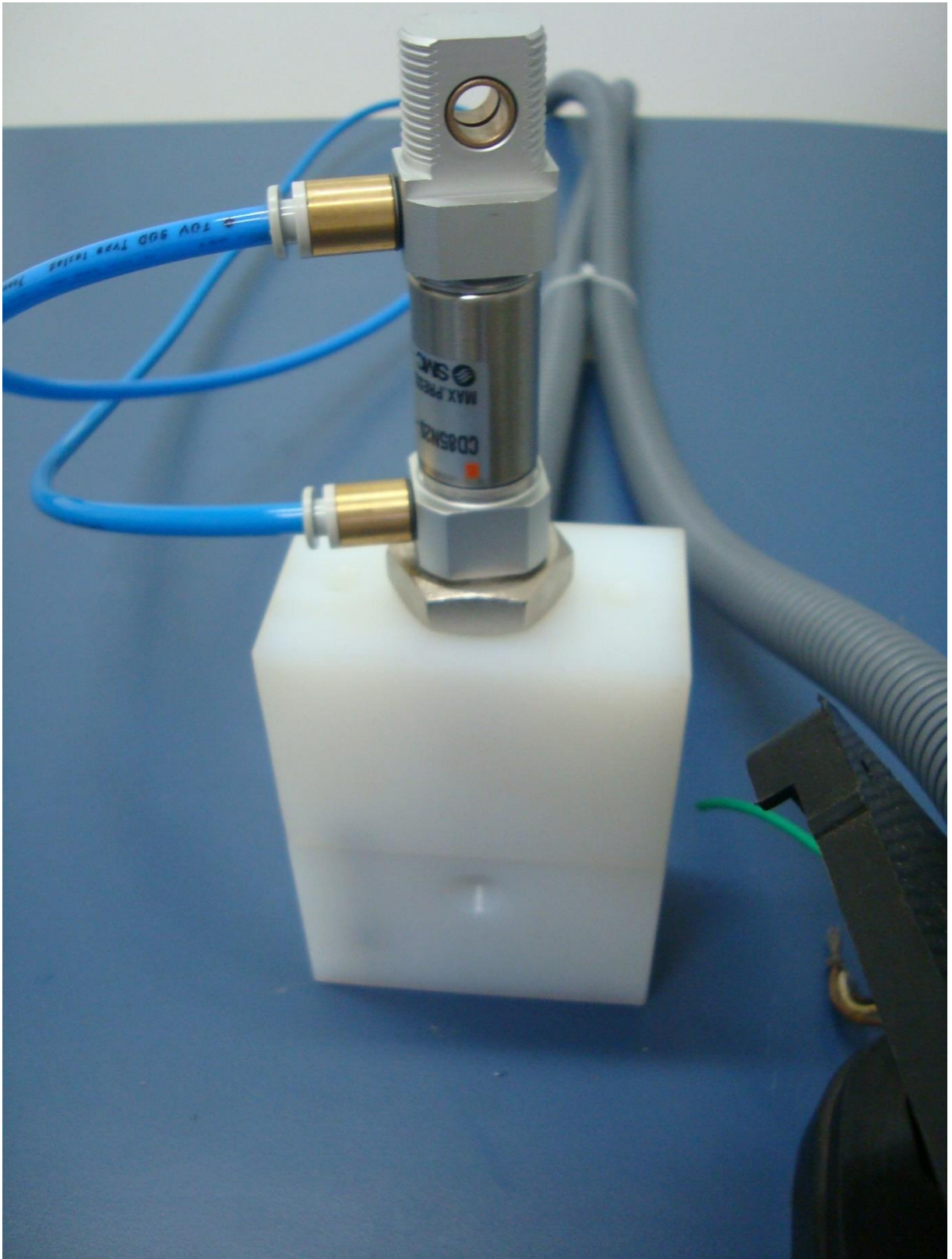
Figura 19: Dispositivo pneumático que prende o fio do motor durante o teste.
