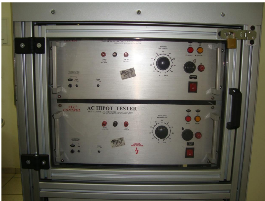
Figura 3: Visão frontal do "HIPOT" e "EARTH tester".
