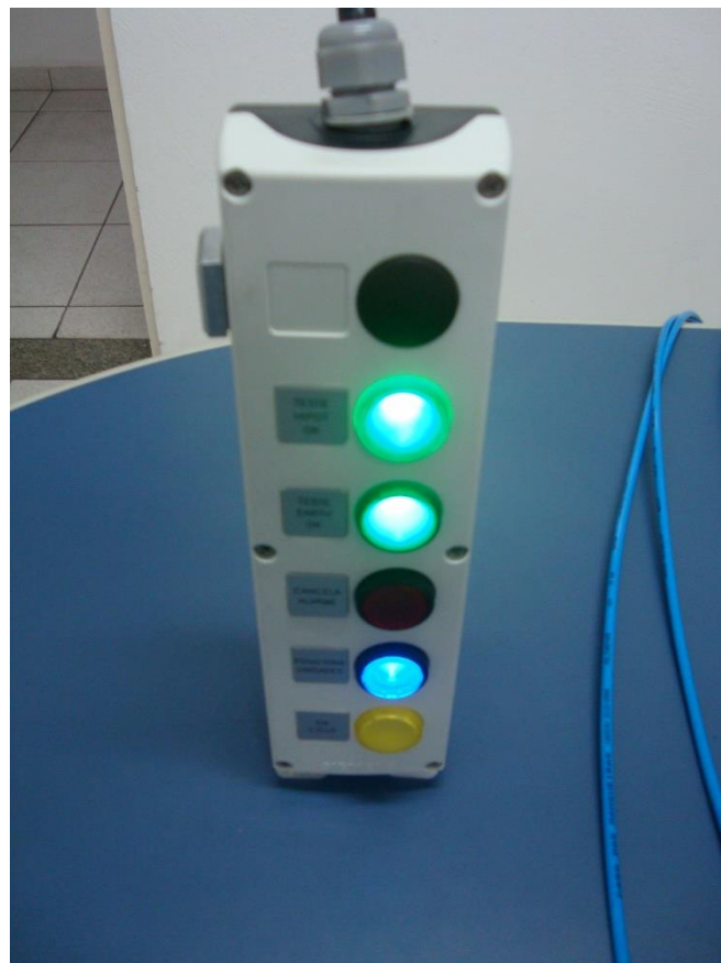
Figura 18: Botoneira para sinalização de auxílio para o operador.
