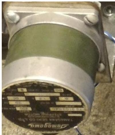
Figura 3.6. Motor de passo utilizado no projeto
