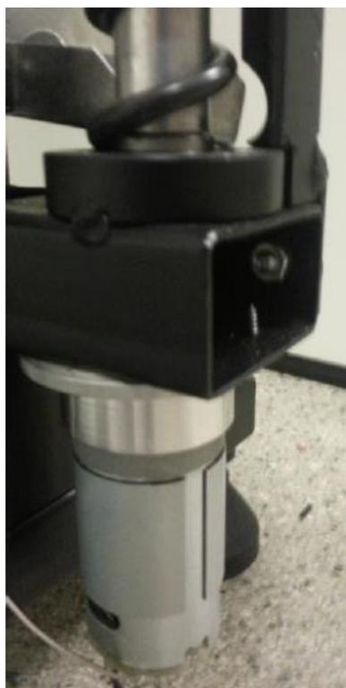
Figura 3.12. Helicoide acoplada ao motor DC
