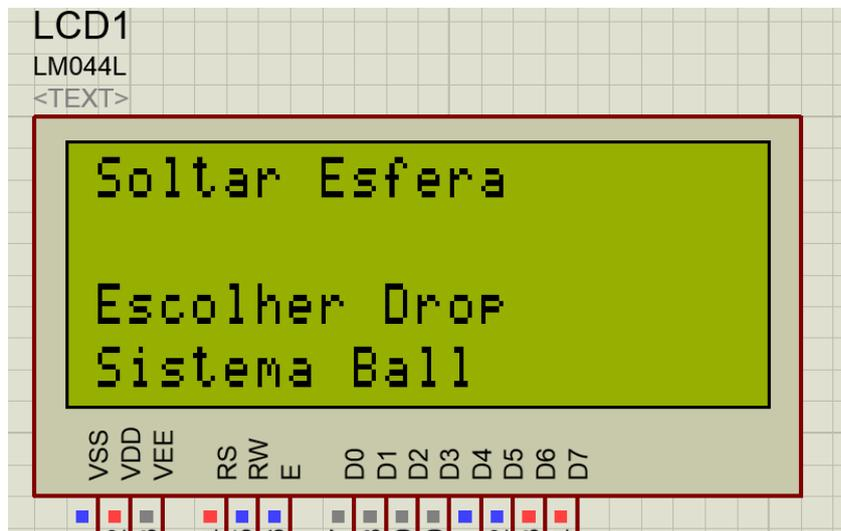
Figura 3.20. Tela de LCD ligada ao microcontrolador
