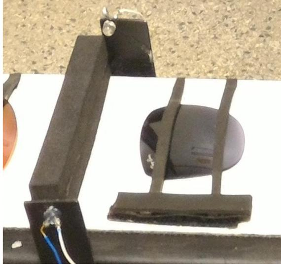
Figura 3.10. Sistema de posicionamento por interrupção de luz
