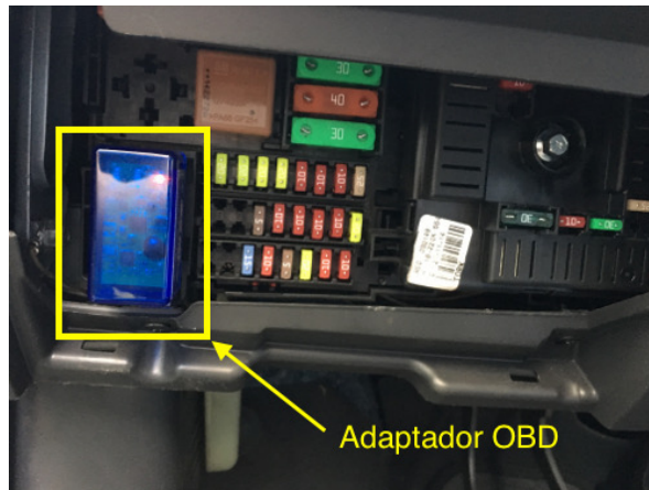
Figura 3.4: Adaptador OBD instalado no veículo
