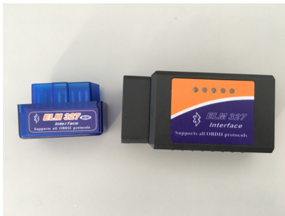
Figura 3.3: Adaptadores OBD utilizados no projeto
