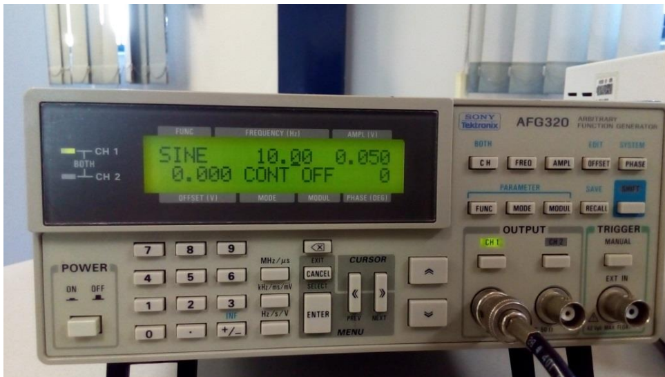
Figura 3-8 Gerador de funções arbitrárias.
