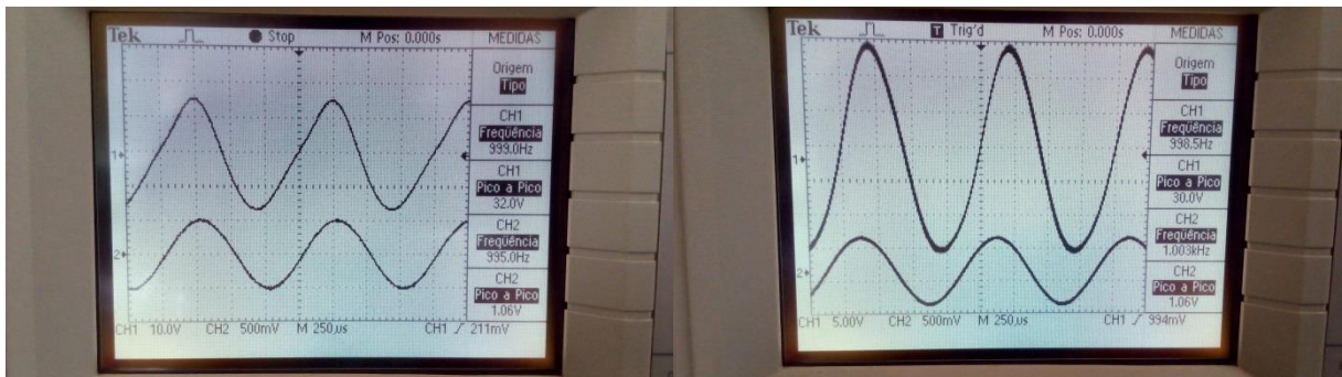
Figura 3-17 Sinais de entrada e saída observados no osciloscópio, para entrada senoidal de 1,0KHz e amplitude 0,5V e chave multiplicadora selecionada x1000; onda superior no osciloscópio é a saída e a inferior a entrada; na direita o capacitor C4 é de valor 100pF e na esquerda 100nF.
