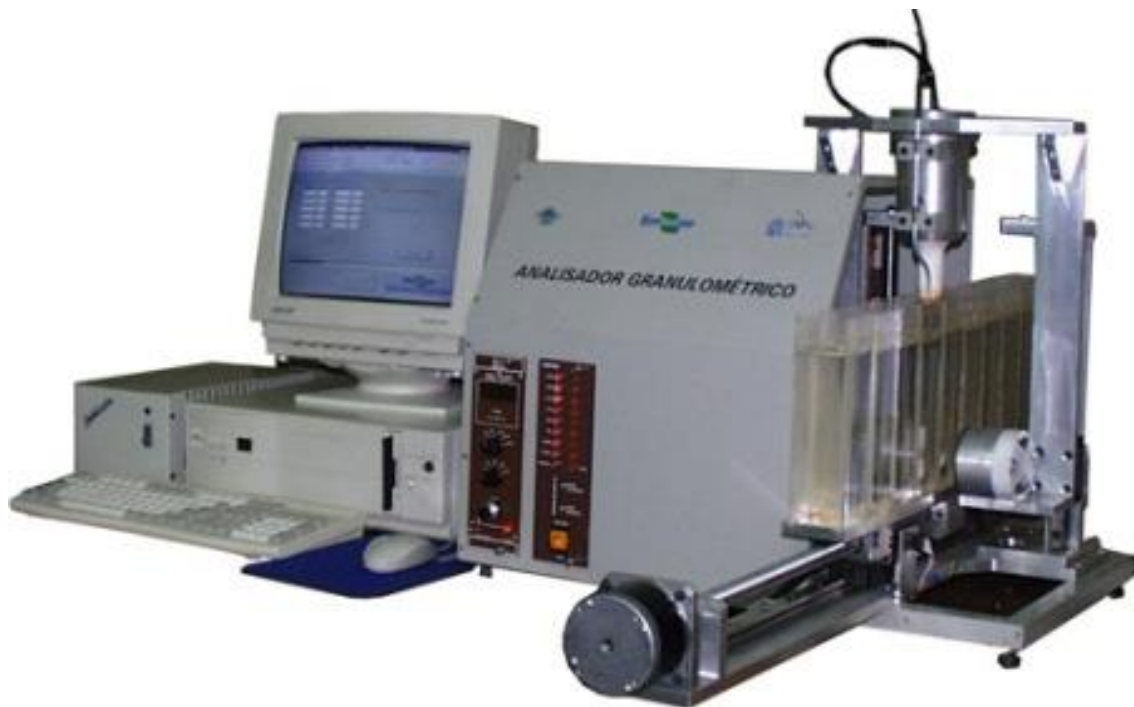
Figura 6 - Analisador granulométrico de solos desenvolvido por Naime et al. (2001).
