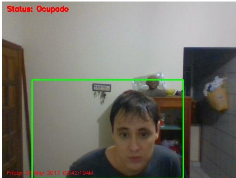
Figura 4.9: Detecção de movimento em ambiente com pouca luz
