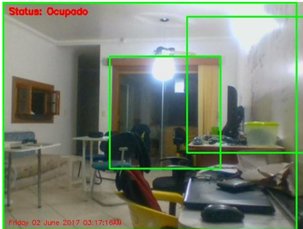
Figura 3.15: Exemplo da saída do algoritmo quando a câmera é movida.
