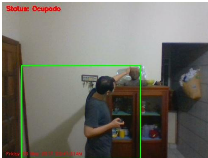
Figura 4.10: Erro de detecção devido à sombras
