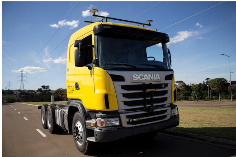
Figura 2.7: Fotografia do caminhão autônomo desenvolvido pelo Laboratório de Robótica Móvel - LRM - ICMC/USP em parceria com a Scania.
