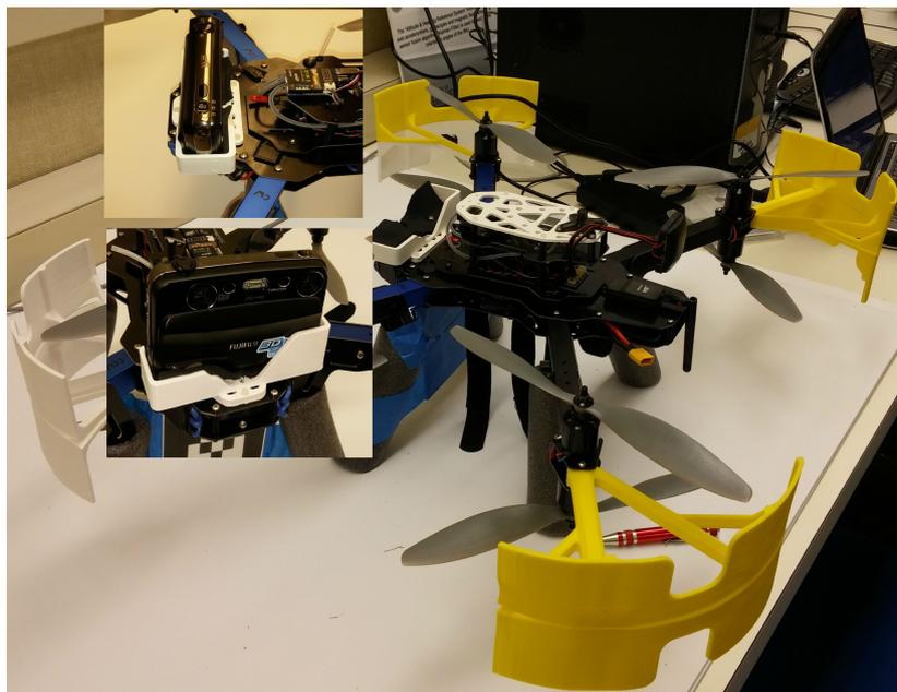
Figura 3.6: Fotografia do Quadricóptero 3DR X8 com suporte para a Câmera 3D
