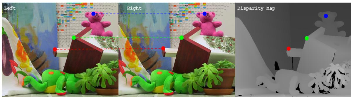
Figura 2.5: Correspondência de pontos homólogos em um par de imagens estéreo. Imagem original retirada de [3].
