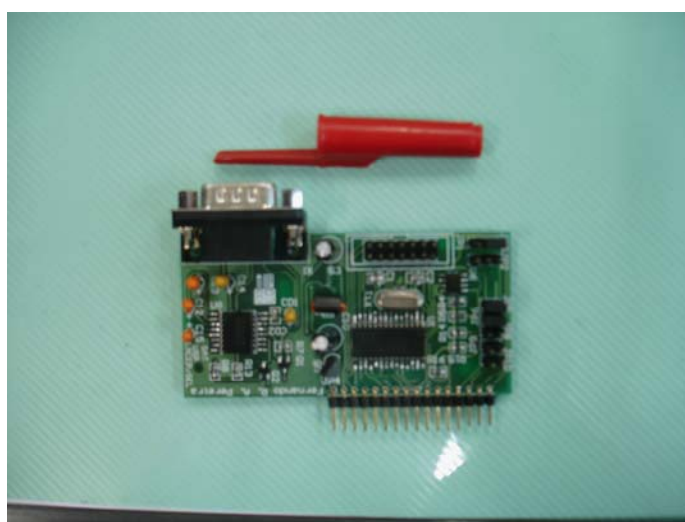
Figura 3-1 - Foto da PCB desenvolvida neste projeto, com a finalidade de formar um sistema para acionar chaves de potência em sistemas trifásicos.
