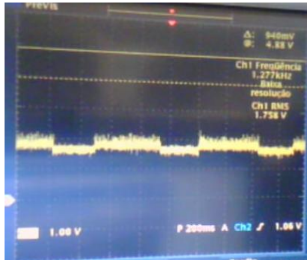
Figura 68: Sinal de saída para o teste 1, com R_2=100\text{ k}\Omega
