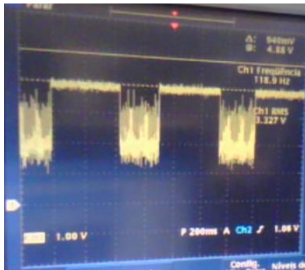
Figura 69: Sinal de saída para o teste 2, com R_2=100\text{ k}\Omega
