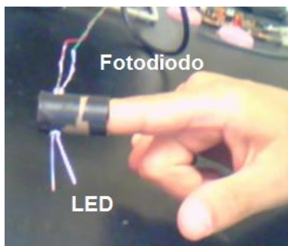
Figura 61: Grampo de dedo para acoplamento dos componentes ópticos
