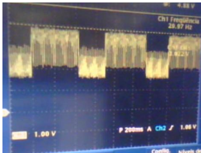
Figura 77: Sinal de saída para o teste 3, com R_2=1M\Omega
